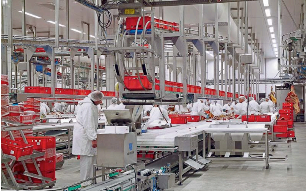
Neben der ergonomischen Gestaltung der Zerlegelinie für jede gewünschte Kapazität bieten die Anlagen sowohl Leerkistenandienung als auch Vollkistenabtransport. Auf Wunsch kann auch eine vollautomatische Reinigung (patentiert) realisiert werden.
